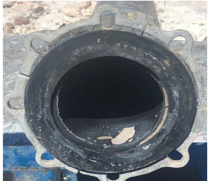
Сравнение отложения осадка: труба Pexgol после 60 дней использования.
