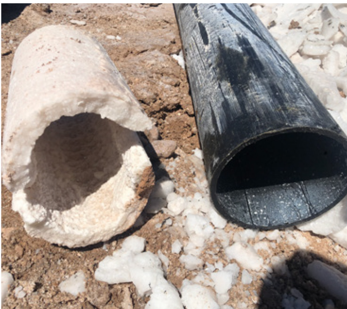
По истечении 30 дней эксплуатации на трубе из ПЭВП образовалась корка толщиной примерно 50 мм.
