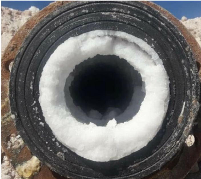
Comparación de sedimentación: tubería HDPE luego de 30 días de uso.
