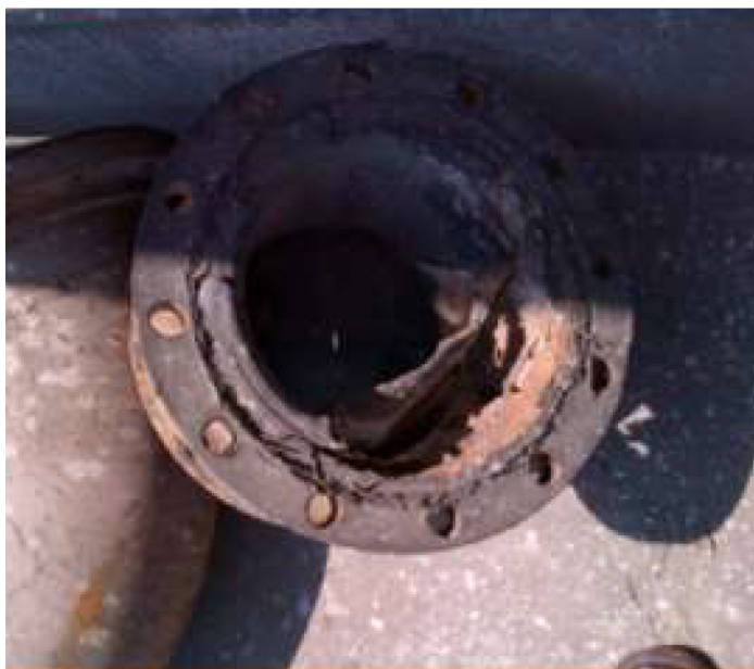
Обрезиненные стальные трубы после 6 месяцев использования
