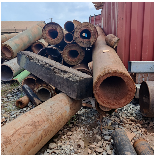
Tuberías de acero incrustadas que fueron reemplazadas.
